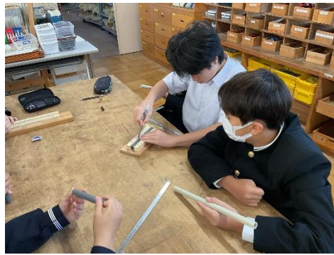
塩ビ素材のパイプに、穴をあける部分のけがきをする
